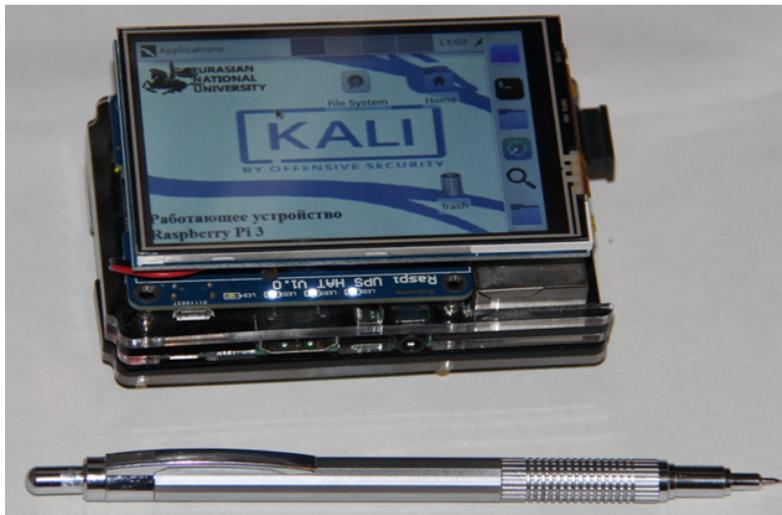
Рисунок 1 – Работающее устройство Raspberry Pi 3
