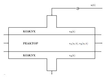
В реактор подается газ, который подвергается экзотермической реакции первого порядка. Реактор имеет внешнюю оболочку (кожух). Через кожух течет жидкость.
